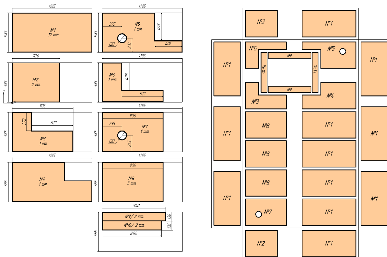
Рисунок 7 – Карта раскроя утеплителя
